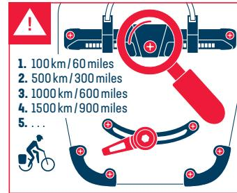
**Regelmäßig** alle Schraub- und Nietverbindungen auf festen Halt überprüfen
