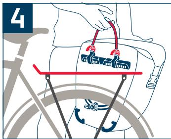
**Zug an Schlaufe öffnet Lasthaken** zur Befestigung und Demontage an Querstrebe
