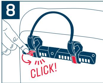
**Arretierung der Lasthaken:** Feststellclips bis zum „Klick“ zusdrücken
