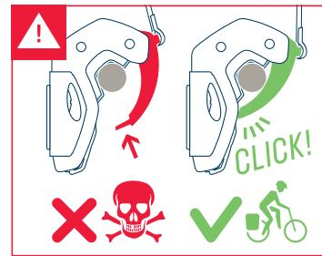
Lasthaken müssen immer vollständig einrasten und das Rohr sauber umschließen
