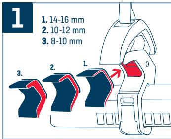
Anpassen an den Rohrdurchmesser durch unterschiedlich starke Gummipads
