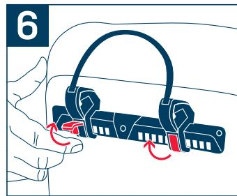
**Öffnen der Lasthakenarretierung** durch Aufklappen der Feststellclips
