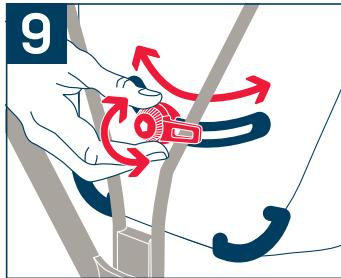
**Drehhaken an Stützstrebe ausrichten** und für sicheren Halt fest arretieren
